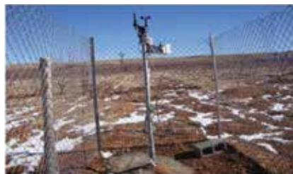
شکل ۵. تصویر سامانه‌ی هواشناسی خودکار IMETOS نصب شده در حوضه‌ی گلستان شیراز
