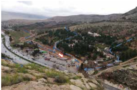
شکل ۳: نمایی از مسیل دروازه‌ی قرآن و خطوط آبی رنگ برای حرکت آب و پیکان سفید حوضچه‌ی آرامش محل خروج آب به‌وسیله‌ی لوله‌ی زیرزمینی است. گوشه‌ی پایین سمت راست تصویر محل تنگه‌ی دروازه‌ی قرآن است (دید به شمال).
